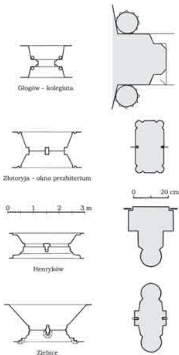
Il. 9. Przekroje poziome okien i przekroje laskowania Fig. 9. Horizontal sections of windows and sections of fluting
